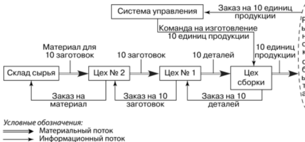
Рис 2.2 Схема тянущей системы управления материальными потоками:
